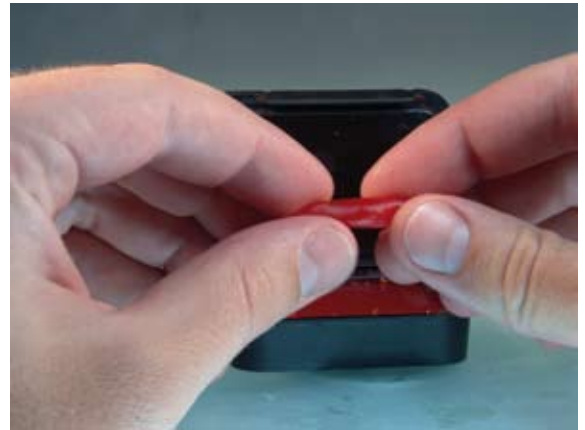
Fig. 19: l'elaborazione e la modellazione manuali sono più efficienti considerando che il materiale ha una consistenza simile a quella della moldina e non attacca
